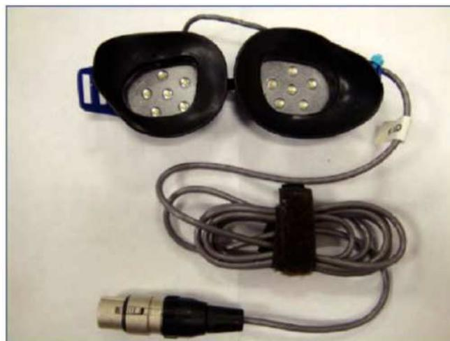
Figura – Gafas de estimulación con 6 LEDs de alta intensidad.
